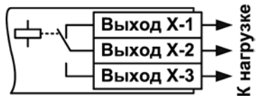
Рисунок Б.2 – Схема подключения нагрузки к ВУ типа Р
